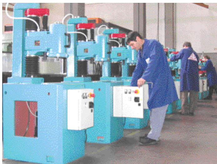
Il reparto di assemblaggio dei lapidelli della linea Elle che Delta produce in cinque modelli differenti a tavola fissa, rotante e oscillante e a elevata automazione
