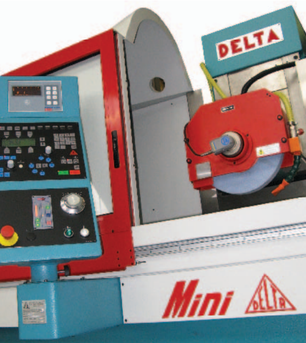
Un dettaglio della rettificatrice Mini 12, superficie rettificabile da 1300x650 mm
