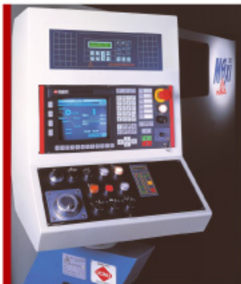
Controllo numerico montato sulla rettificatrice Maxi della Delta
