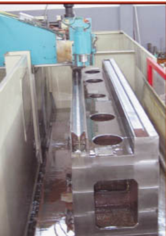
Lavorazioni di rettifica delle guide piane e a "V" di basamenti effettuate sulla MAXI 3000/1100 CNC
