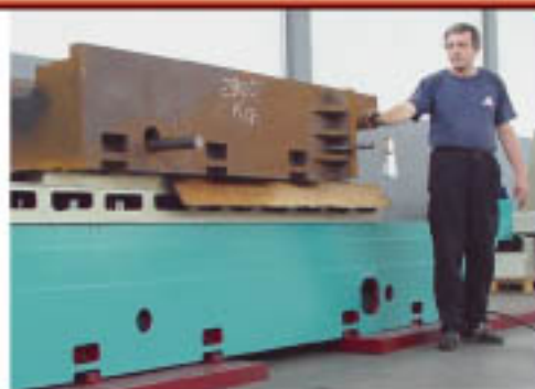
Sostentamento idrostatico su tutti gli assi macchina. È suff. La pressione di un dito che agisce sulla tavola per spostare carichi considerevoli
