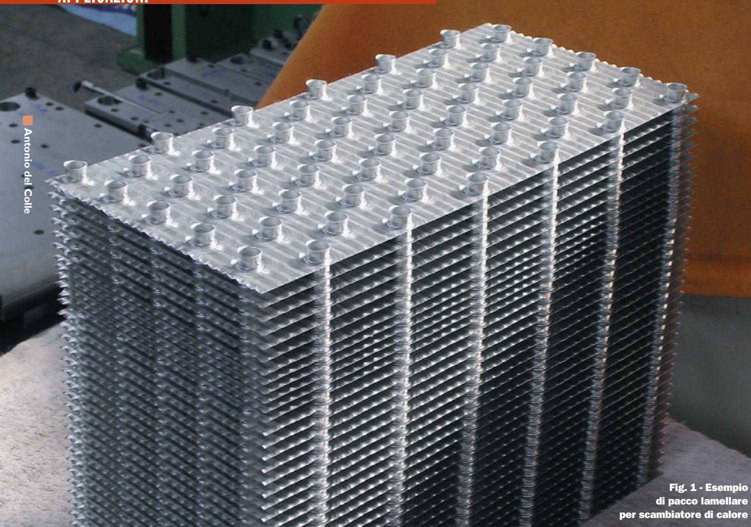
Fig. 1 - Esempio di pacco lamellare per scambiatore di calore
