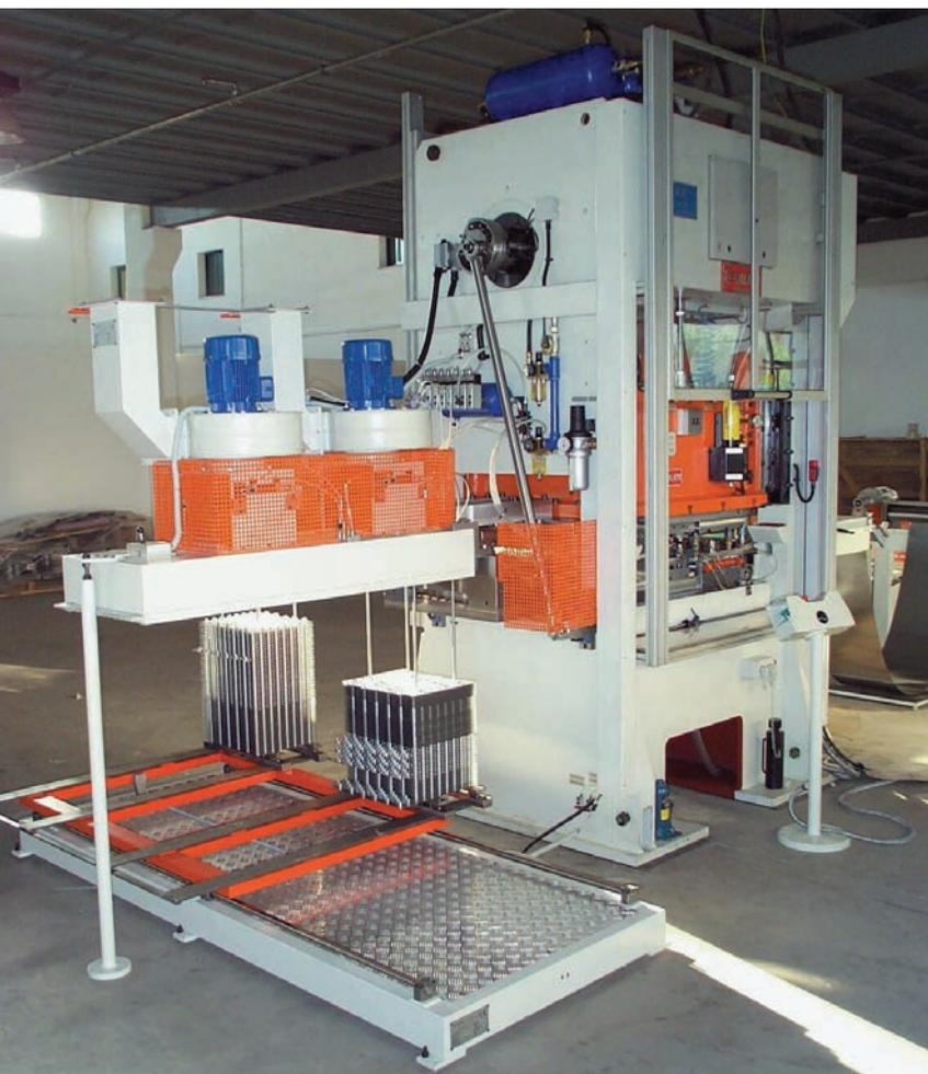
**Fig. 4 - Linea completa di produzione per lamelle di scambiatori: A.M.P. possiede completamente questa tecnologia e offre dette linee "chiavi in mano"**
