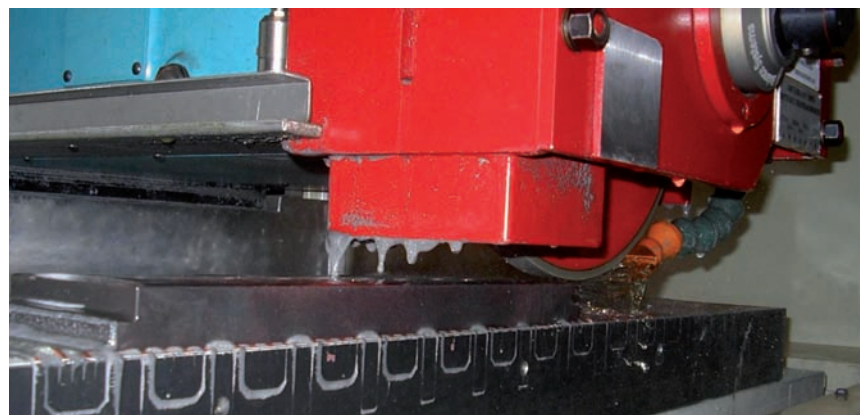
Rettifica di una lastra metallica su Mini 12 diastep, rettificatrice a montante mobile della Delta S.p.A.
