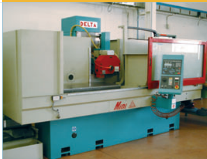
L'attrezzatura di Rigon è dotata di una rettificatrice per piani Delta Mini 12 con superficie massima rettificabile 1.300 x 650 mm.
