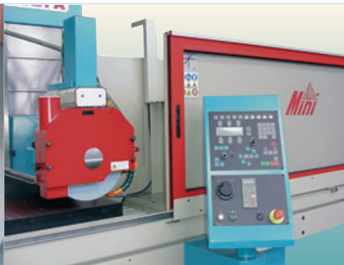
Le rettificatrici per superfici piane a montante mobile della linea Mini sono macchine di avanzata tecnologia.
