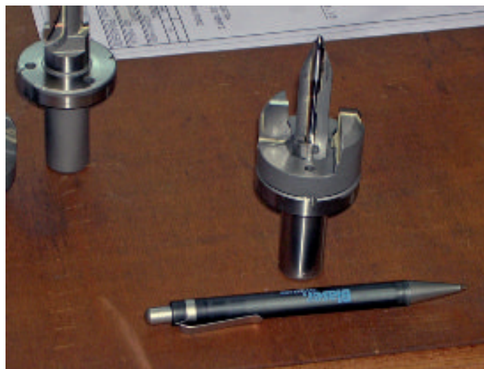
Fig. 2 - Altro esempio della produzione Emmebi: utensili speciali per la lavorazione dei moltissimi tipi di getti d'ottone prodotti dal gruppo BraWO-Almag
