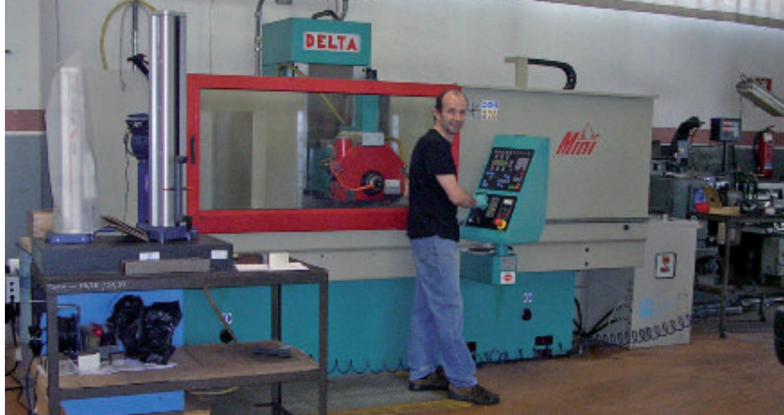
Fig. 6 - La rettificatrice MINI 12 Diastep in funzione alla Emmebi srl
