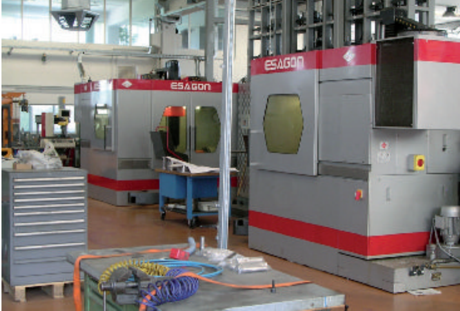
Fig. 3 - L'azienda dispone di un'eccellente dotazione di macchine utensili gestite con i criteri più avanzati: qui un FMS organizzato su due centri di lavoro Exagon e dotato di un grande magazzino Fastems per pezzi pallettizzati. La maggior parte della produzione Emmebi è assicurata da questo sistema che opera 24 ore su 24
