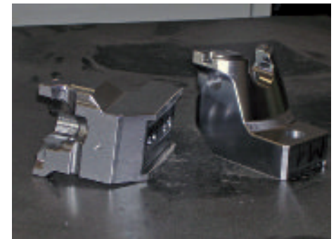
Fig. 4 - Componenti di attrezzature speciali per lavorazioni: qui le superfici piane rettificate sono di minore estensione ma esigono precisioni molto superiori
