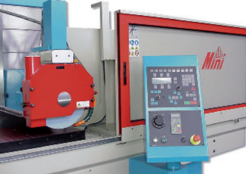
Fig. 9 - Diastep: particolare del pulpito di comando
