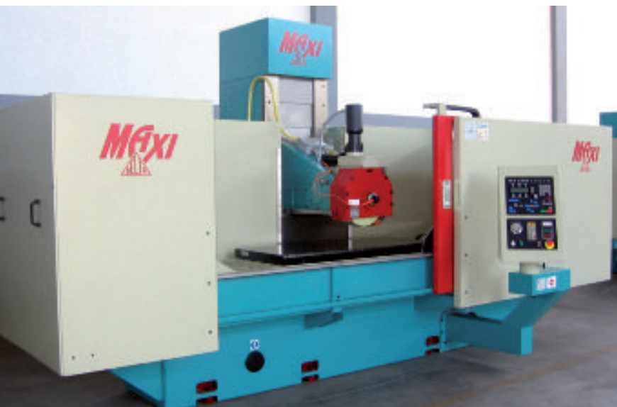
La rettificatrice per piani Delta Maxi 1500/750 CN a montante mobile e dettaglio della testa portamola.
