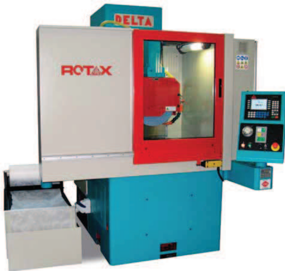
Tavola rotante equipaggiata con piano magnetico elettropermanente
