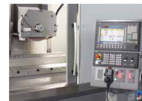
Un CNC Siemens installato su rettificatrice MAXI 2000/750
