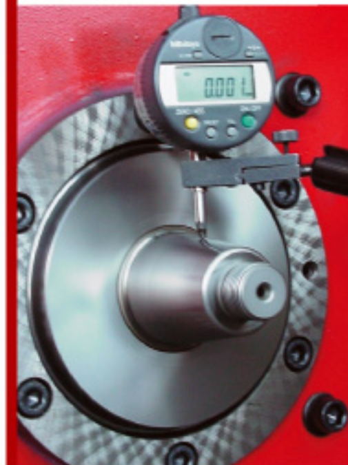
Il cuscinetto idrodinamico Mackensen garantisce elevati gradi di finitura e ottimi livelli di precisione
