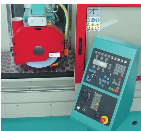
L'unità Diastep gestisce tutte le funzioni macchina, visualizza gli assi e può programmare un ciclo automatico di rettifica mediante un menu guidato.
