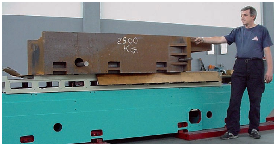
Sostentamento idrostatico: il meato d'olio permette la traslazione della tavola con uno sforzo minimo anche in presenza di carichi estremamente elevati
