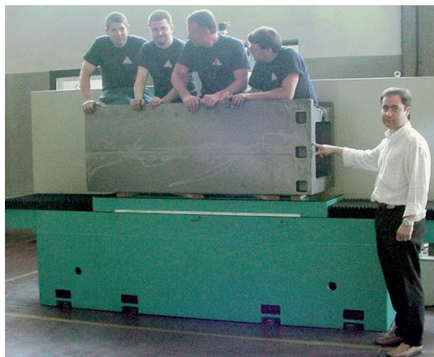
**Grazie al sostentamento idrostatico il meato d'olio permette la traslazione della tavola con uno sforzo minimo anche in presenza di carichi estremamente elevati.**
