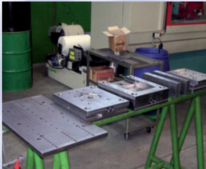
Fig. 3 - Piastre portastampo e inserti che esigono rettifica in piano di precisione. Alla De Agnoi, queste operazioni sono eseguite su rettificatrici Delta Mini
