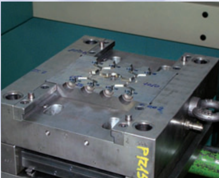
Fig. 2 - Dettagli di uno stampo: sono visibili le numerose superfici piane da rettificare con precisione
