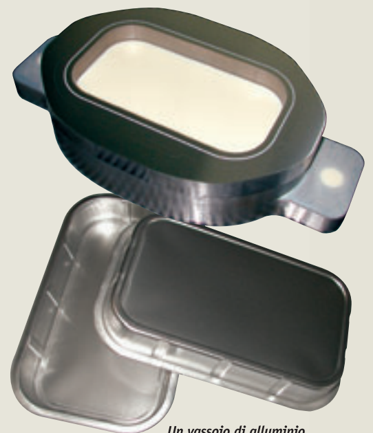
Un vassoio di alluminio e lo stampo per realizzarlo
