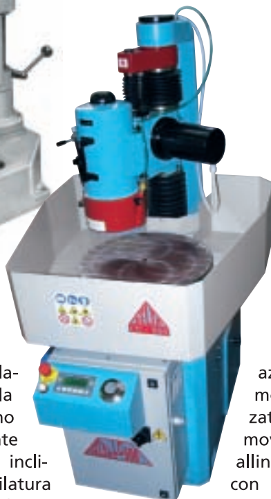
L11E: avanzamento millesimale elettronico visualizzato applicabile a tutta la linea LC
