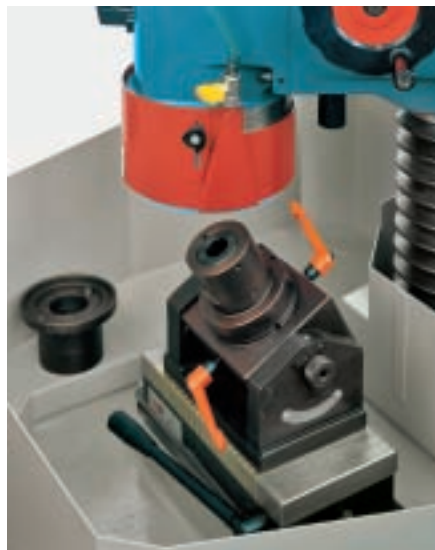
Morsa inclinabile per l'affilatura dei punzoni (accessorio L16)
