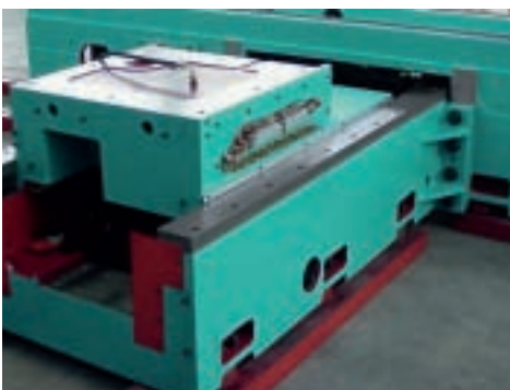
Fig. E - Slitta portamontante di una rettificatrice Delta Maxi al montaggio. Particolare delle guide precaricate dell'asse trasversale
