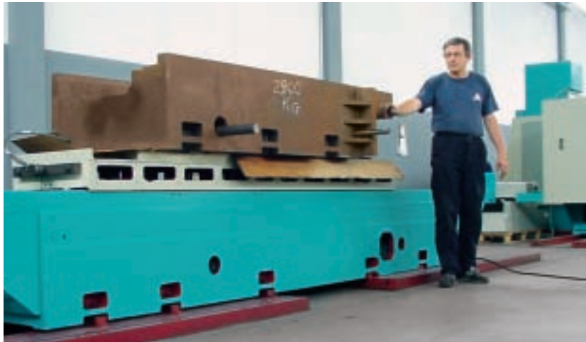
Fig. C - Tavola idrostatica di una rettificatrice Delta Maxi 1500/750. Con attrito pressoché nullo è sufficiente la pressione di un dito per spostare carichi anche molto elevati
