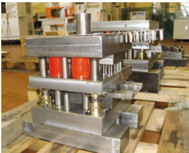
La precisione nella costruzione di guida, punzone e matrice garantiscono la perfetta riuscita della fase di tranciatura.
