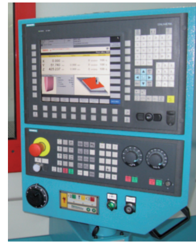
CNC Delta su unità di controllo Siemens Sinumerik 840Di.
