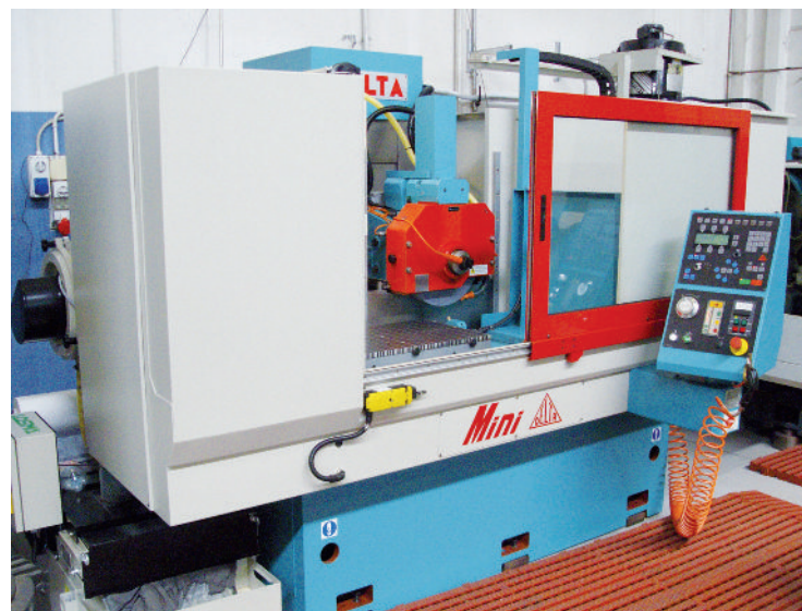
La rettificatrice Delta Mini 7 che equipaggia l'attrezziera di Giurgola Stampi.
