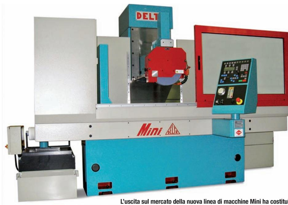
**L'uscita sul mercato della nuova linea di macchine Mini ha costituito una nuova sfida per Delta, in quanto è stato introdotto il montante mobile anche su rettificatrici per superfici piane di ridotte dimensioni**
