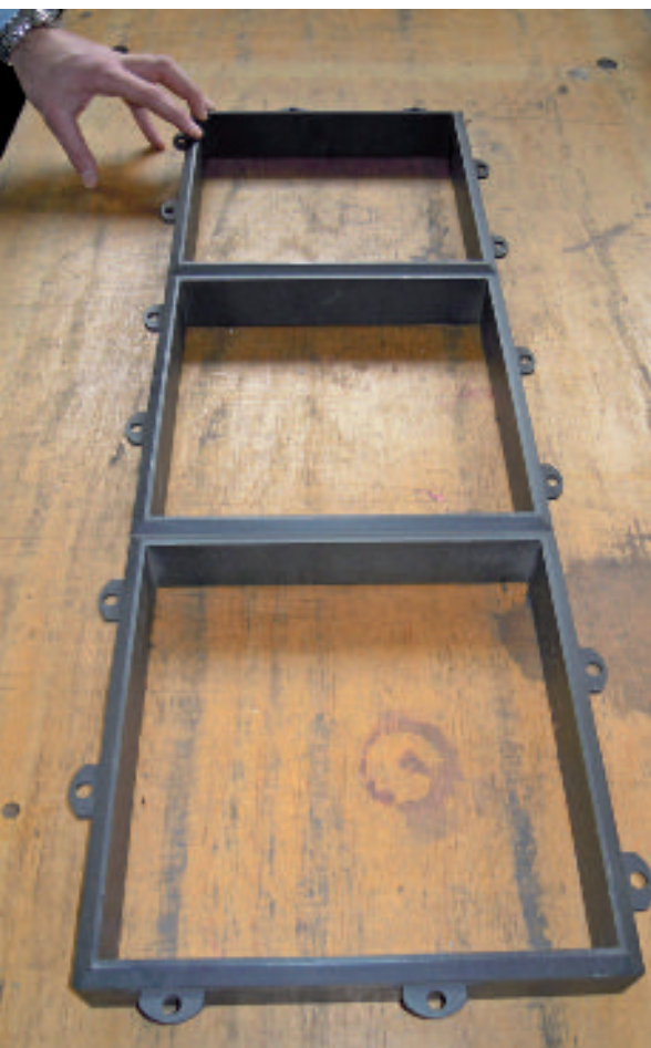
Particolare stampo costituito da tre forme quadrate.
