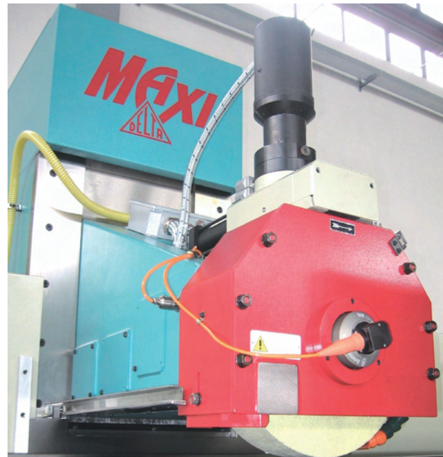
Delta Maxi 1500/750: particolare della testa porta-mola.
