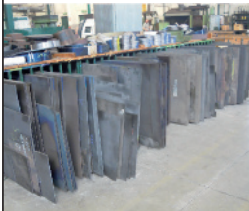
Il materiale grezzo viene fornito alla Negri Lame sotto forma di lastre (a sinistra) o tubi (a destra). Sullo sfondo della foto di destra si notano il reparto di tornitura e il forno per il trattamento termico.
