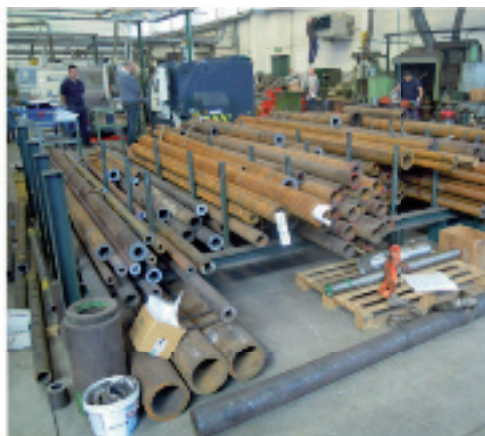
Il materiale grezzo viene fornito alla Negri Lame sotto forma di lastre (a sinistra) o tubi (a destra). Sullo sfondo della foto di destra si notano il reparto di tornitura e il forno per il trattamento termico.
