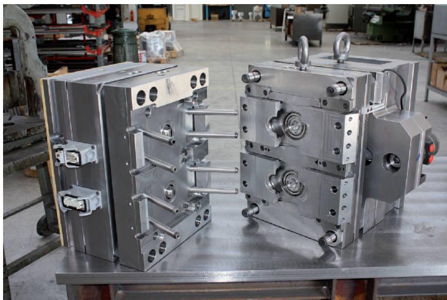
Stampo per corpo valvola per bevande rettificato con MAXI 1500/750
