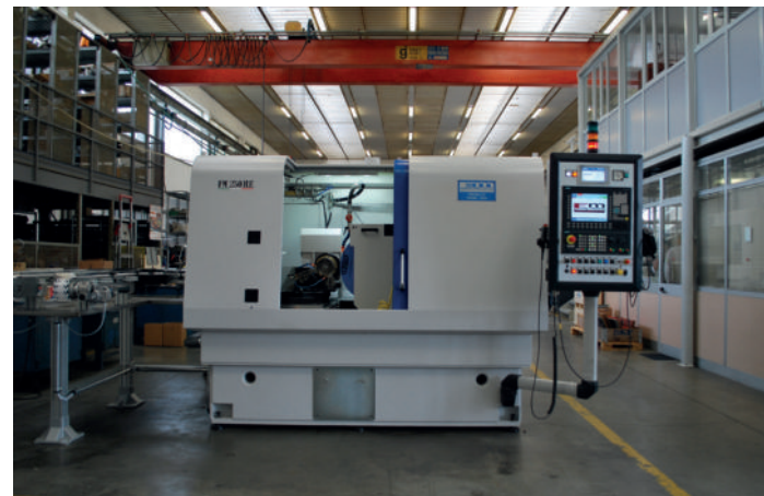
FM 250 RE di Faletto Meccanica è una macchina per la rettifica esterna di cuscinetti e altri componenti
